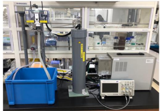
図1 フロー式プラズマ発生装置
